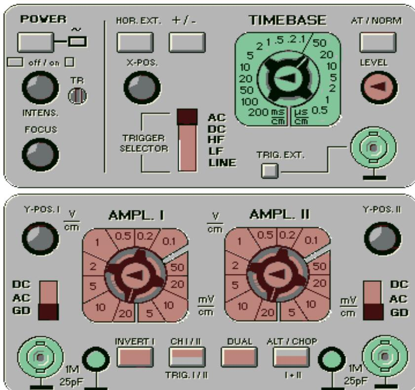
A primera vista un osciloscopio se parece a una pequeña televisión portátil, salvo una rejilla que ocupa la pantalla y el mayor número de controles que posee. En la siguiente figura se representan estos controles distribuidos en cinco secciones:
