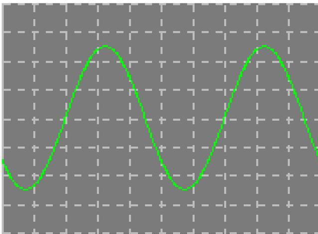
De esta forma la acción combinada del trazado horizontal y de la deflexión vertical traza la gráfica de la señal en la pantalla. La sección de disparo es necesaria para estabilizar las señales repetitivas (se asegura que el trazado comience en el mismo punto de la señal repetitiva).
