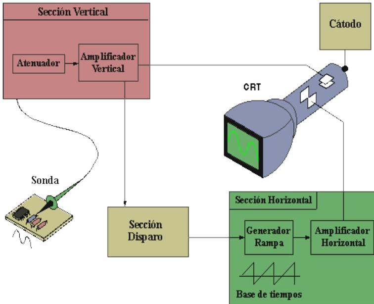
Cuando se conecta la sonda a un circuito, la señal atraviesa esta última y se dirige a la sección vertical. Dependiendo de donde situemos el mando del amplificador vertical atenuaremos la señal ó la amplificaremos.
