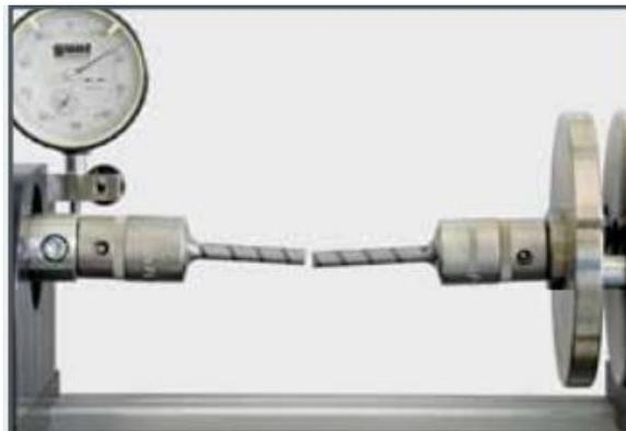
Procedimiento de ensayo en el ensayo de torsión:
