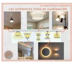
DIRECTA SEMIDIRECTA DIFUSA SEMIINDIRECTA INDIRECTA Flujo dirigido La mayor parte 50 % hacia el Casi toda la luz La mayor parte hacia el suelo se dirige hacia del flujo se va hacia el suelo y 50% el suelo hacia el techo proviene del techo techo
