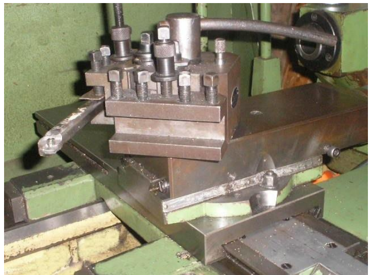
Torre con regulador de altura
