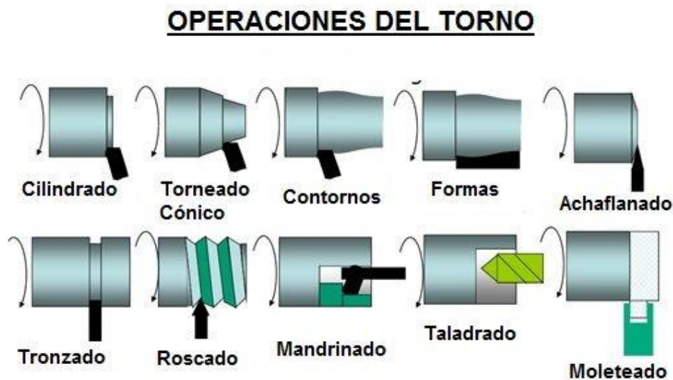
Ilustración 5 Operaciones del torno
