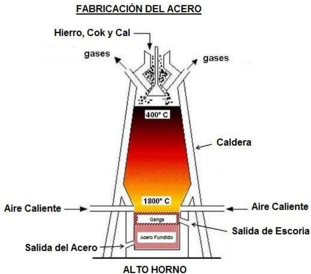
Ilustración 22 Esquema de un alto horno
