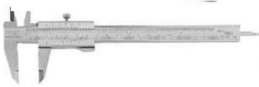
Calibre de Tornillo de Freno: es el más común y el que usamos en el taller. Usamos el tornillo para frenar la regla móvil y así poder hacer la lectura.
