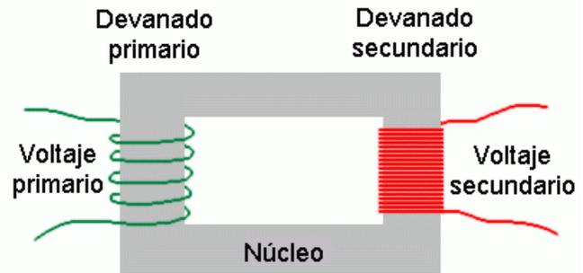
**Como ves, la Bobina (o Devanado) primario no se toca con el secundario, sin embargo se genera un campo magnético y eso hace que la bobina secundaria tenga energía.**
