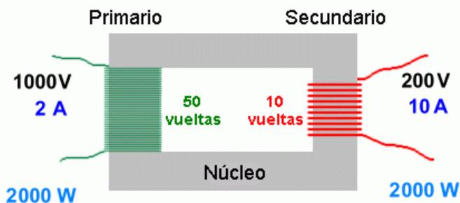
Si miras la siguiente imagen, Notaras un transformador, si ves de ambos lados tenemos 2000 W y eso es porque el factor de potencia se mantiene en ambos lados y la fórmula de potencia es **P = Tensión x Corriente**.
