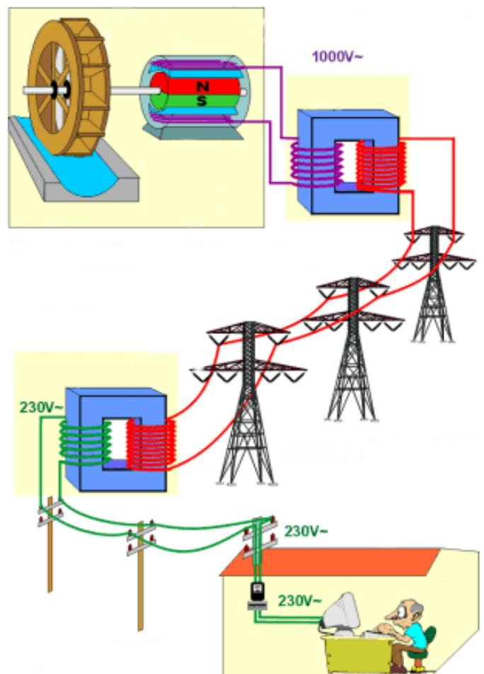
Su utilización permite el uso de Alta tensión para el transporte de energía eléctrica a grandes distancias con pérdidas de energía reducidas y su posterior conversión a Bajas Tensiones para poder ser utilizado por los consumidores.
