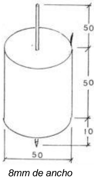
El cuerpo del rotor es un cilindro de hojalata de 5 cm de altura y 5 cm de diámetro
