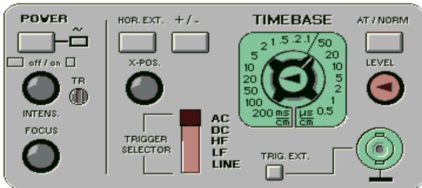
A primera vista un osciloscopio se parece a una pequeña televisión portátil, salvo una rejilla que ocupa la pantalla y el mayor número de controles que posee. En la siguiente figura se representan estos controles distribuidos en cinco secciones:
