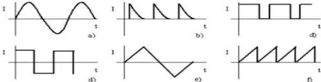
Ondas de régimen periódico: a) Senoidal, b) Impulsos positivos, c) Rectangular de impulsos positivos, d) Cuadrada, e) Triangular, f) Diente de sierra.
