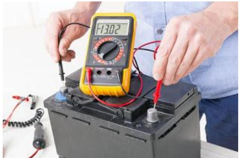
¿Te diste cuenta el detalle de la imagen anterior? mira la pantalla del Tester. ¿Qué marca?  $-13,02V$ . ¿Negativo? No asustarse, puede ser. Como dije el Multímetro resta valores, si colocas las puntas de una manera (recuerda, en paralelo siempre) te dará un valor. Si donde antes tenías el positivo ahora pones la del negativo, y al revés, verás cómo cambia el símbolo de más a menos (o al revés). Además, cuidado cómo conectamos estas puntas al propio Multímetro.
