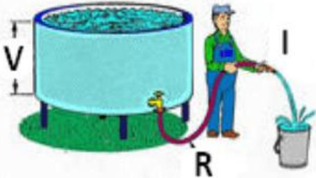
**Como ves en el Dibujo, la tensión se puede comparar a la cantidad de Agua y la Corriente se puede comparar a la velocidad o la corriente del agua... claro que es una comparación y en la electricidad lo que circula no es agua sino electrones que son invisibles.**
