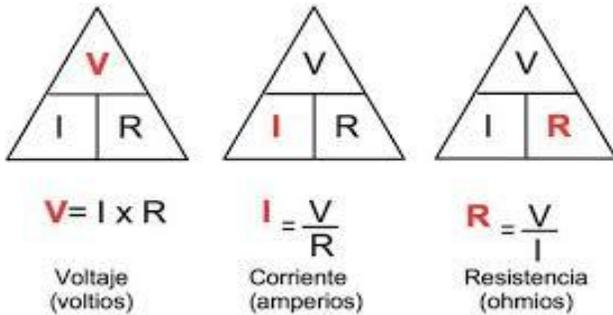
Ahora ya sabemos que debemos colocar una resistencia de 450 Ohm para garantizar que el led no se queme, pero existe una dificultad, si vamos a una casa de electrónica y le decimos “me das una resistencia de 450 Ohm”, lo más probable es que se nos rían en la cara por que no existe ese valor comercial de resistencia, así que debemos buscar un valor cercano (que sea mayor al que calculamos para que no se queme el led), el valor comercial más cercano al que calculamos es de 470 Ohms.
