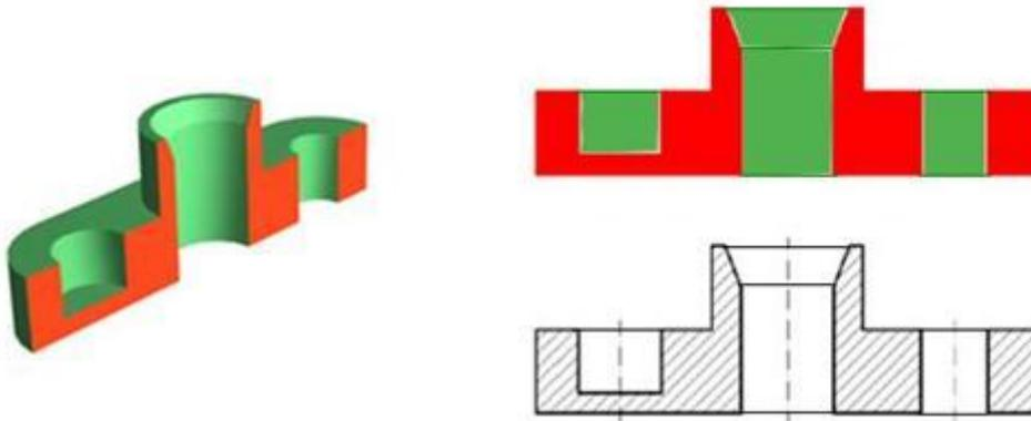
Cuando en la representación gráfica de una vista cortada idealmente por uno o varios planos se dibuja no solo la sección rayada producida por el corte imaginario, sino también el resto de la pieza que queda detrás del plano de corte se dice que se ha efectuado una representación en corte.
