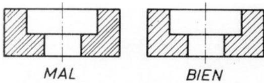
Cuando el plano que produce el corte coincide con uno de los planos de simetría, no es necesario indicar el camino del corte ni las flechas indicadoras del sentido de observación
