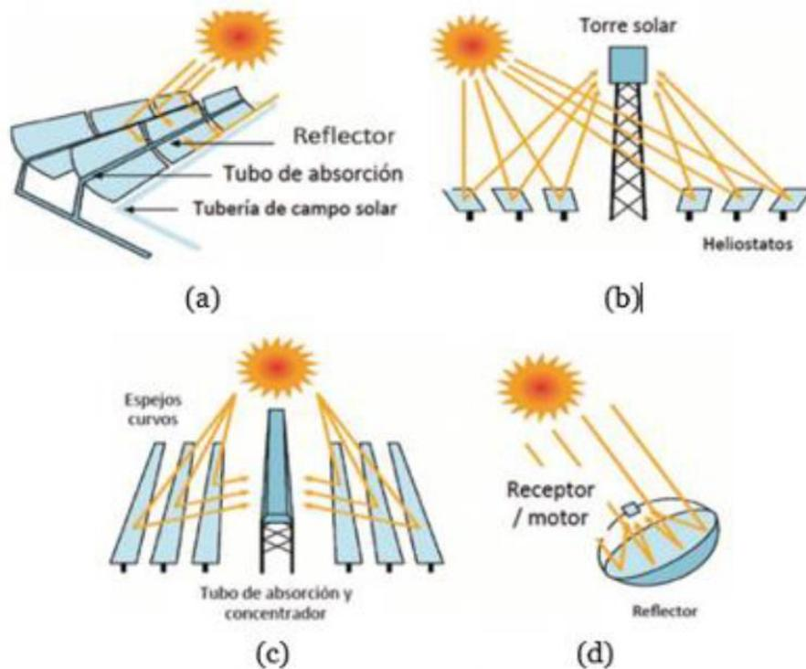
. Tipos de tecnología CSP, (a) Colectores Cilindro Parabólico; (b) Torres Solares; (c) Colector Linear (d) Disco de Stirling
