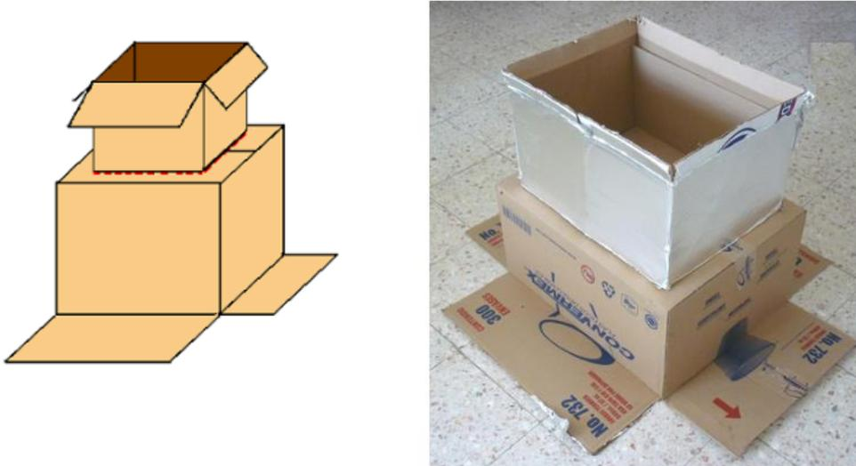
Corta con un cúter el fondo de la caja grande por las líneas marcadas de manera que la caja pequeña se pueda introducir en la caja grande quedando una cámara de aire entre las paredes de las dos cajas de al menos 4 cm.
