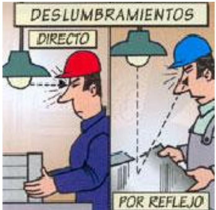
Se debe evitar que los puestos de trabajo en general, y los que tienen pantallas de visualización de datos en particular, estén situados frente o contra una ventana o una superficie que tenga una luminancia elevada; por otra parte, las ventanas de dichos puestos deben estar dotadas de cortinas o persianas opacas y regulables, preferentemente de láminas verticales.
