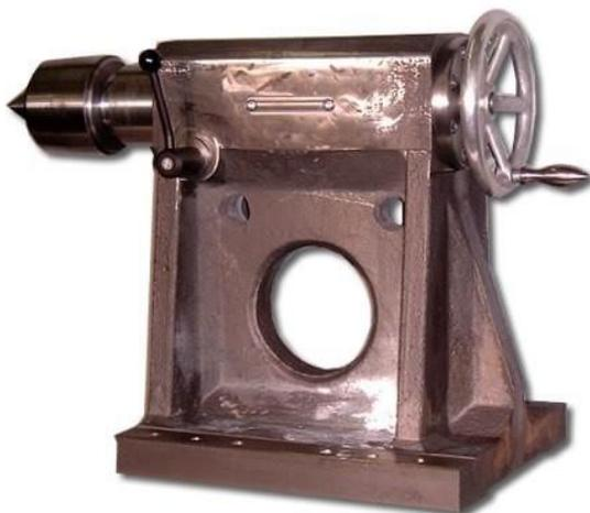
La contrapunta es de fundición, con una perforación cuyo eje es coincidente con el eje del torno. En la misma, corre el manguito, pínula o cañón. Su extremo izquierdo posee una perforación cónica (*cono Morse*), para recibir mandriles portabrocas y puntos. El otro extremo tiene montada una tuerca de bronce, que un conjunto con un tornillo interior solidario con un volante, extrae u oculta el manguito dentro de la contrapunta.
