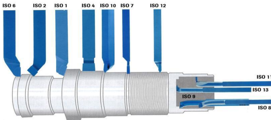
Ejemplo de las diferentes operaciones en una sola pieza
