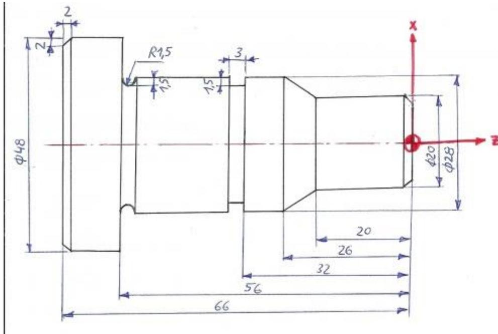
Cuáles de las operaciones del torno (imagen del repaso) aplicarías para lograr la pieza que se pide?
