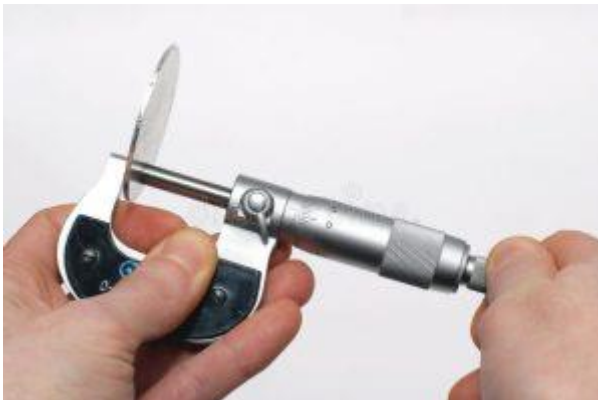
Ilustración 2 Vista del uso del micrómetro
