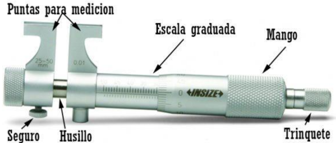
Ilustración 4 Micrómetro para medir interiores
