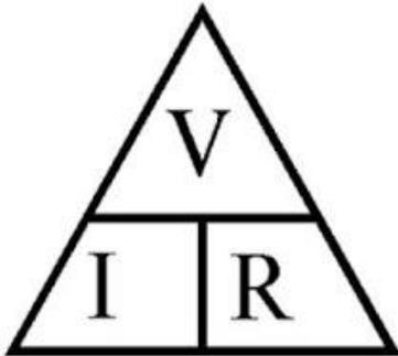
aplicada provoca la circulación de una corriente de intensidad (I) a través de la resistencia (R).
