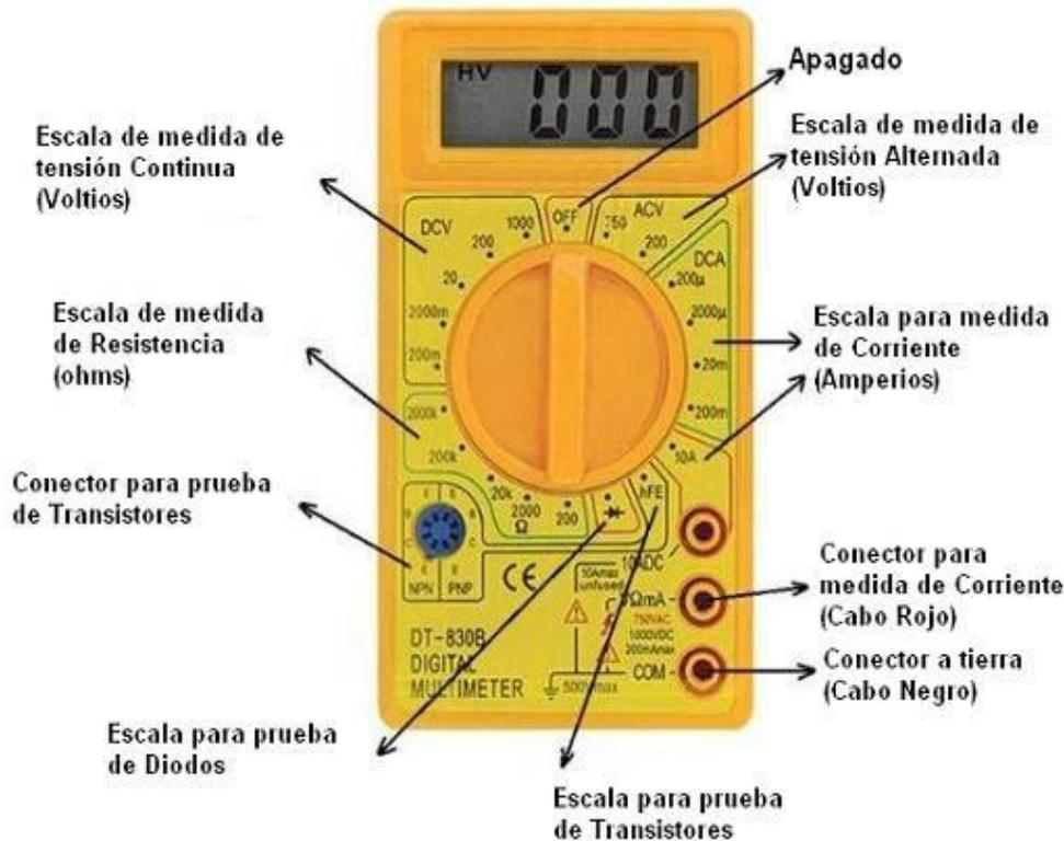
Allí notamos que la **tensión continua** (DCV) tiene las escalas de medición 200mV, 2000mV, 20V, 200V y 1000V pero La **tensión Alterna** (ACV) tiene solo las escalas de medición 750 y 200 Voltios.
