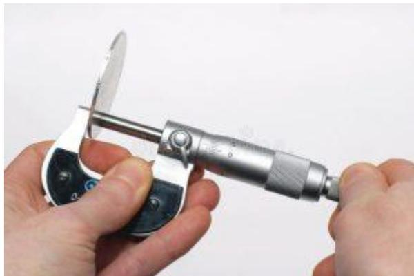
*Ilustración 2 Vista del uso del micrómetro*
