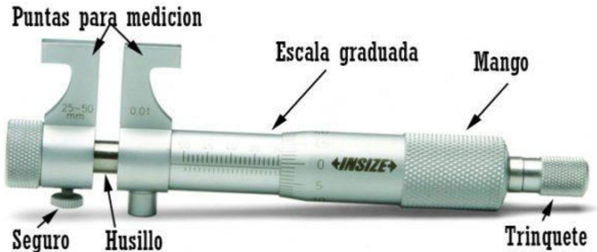
Ilustración 4 Micrómetro para medir interiores
