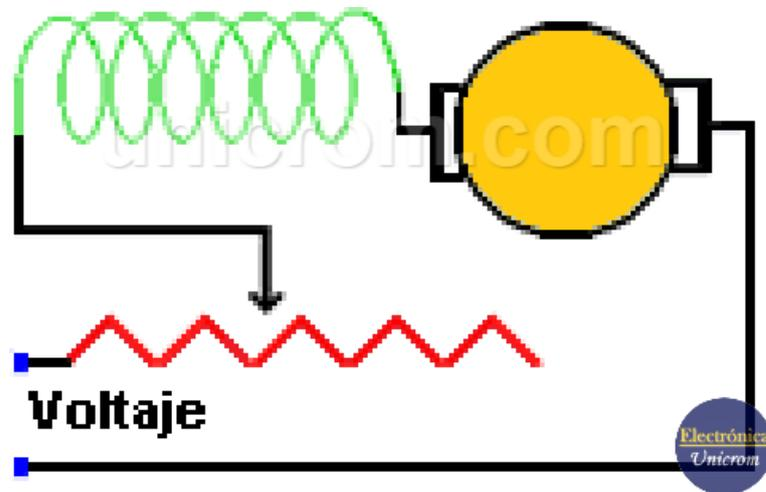
2. **Por conmutación de resistencias:** Al variar la conexión (conmutar) entre los bornes numerados, se varía la resistencia y por ende la cantidad de corriente que se entrega al motor. A mayor resistencia menor corriente.
