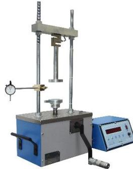
Este ensayo determina la resistencia de un material ante un esfuerzo o carga por compresión. Pese a ser menos utilizado que, por ejemplo, el ensayo de tracción, esta práctica es de uso habitual en el hormigón o el cemento e incluso para valorar el aguante de piezas acabadas.
