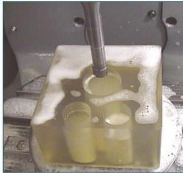
Figura 3 Mecanizado de vidrio Zerodur. (Fotografía Sauer-DMG)
