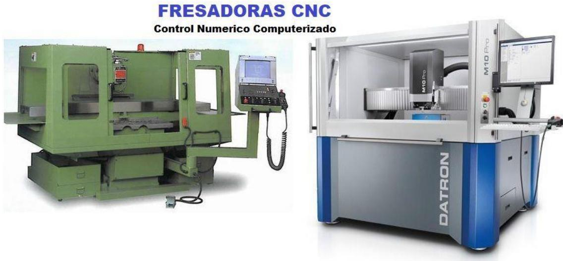
Las primeras fresadoras se automatizaban manual o mecánicamente, pero los avances tecnológicos han llevado al desarrollo del Control Numérico Computacional para automatizar los procesos de las máquinas.
