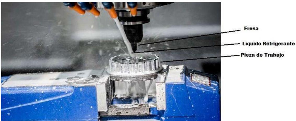
Una máquina fresadora es una herramienta diseñada para mecanizar metales, madera y otros materiales sólidos. También se conoce como máquina multitarea ya que son máquinas multiusos capaces de fresar y también de torneear los materiales.
