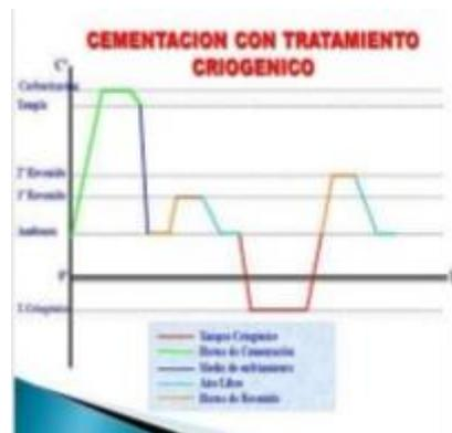
El tratamiento criogénico convencional consiste en enfriar lentamente el material hasta llegar a unos  $-180^{\circ}\text{C}$ , mantenerlo a esa temperatura durante un periodo prolongado de tiempo y volver a calentarlo hasta la temperatura ambiente. Tiene en su larga duración un inconveniente claro.
