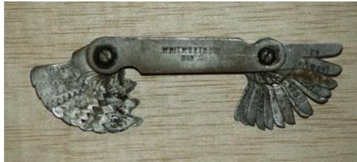
Galga para medir grosores de chapa marcada con seis medidas de chapa de Plomo y trece medidas de chapa de Zinc.
