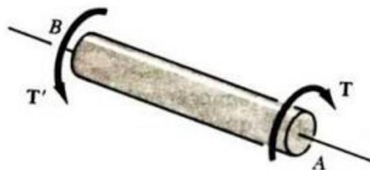
Los elementos de máquinas que transmiten potencia mecánica por medio de su movimiento de giro se denominarán **ÁRBOLES**. Estos elementos estarán sometidos principalmente a flexión y a torsión. Un ejemplo muy común son los árboles cigüeñales de los motores como dijimos anteriormente.
