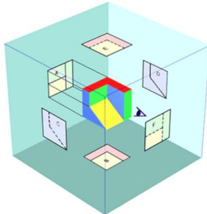
Una vez realizadas las seis proyecciones ortogonales sobre las caras del cubo, y manteniendo fija, la cara de la proyección del alzado (A), se procede a obtener el desarrollo del cubo, que como puede apreciarse en las figuras, es diferente según el sistema utilizado
