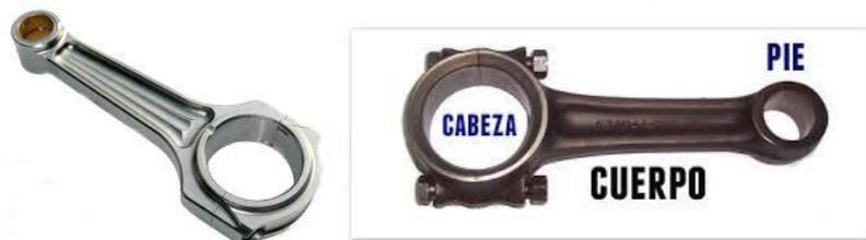
La biela es el elemento que une la manivela con la barra, es decir, que transforma el movimiento circular en el movimiento de traslación.
